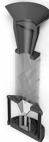
Das Scott Volumeter Kit dient zur Ermittlung der Schüttdichte von unterschiedlichen Pulvern gemäß DIN ISO 3923. Infolge unterschiedlicher Schüttdichten lassen sich geringe Abweichungen hinsichtlich Partikelgröße und -struktur ermitteln.
