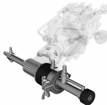
Der gekühlte Pulverinjektor ist eine Zusatzkomponente für das Central Injector Kit. Er wird zusammen mit dem Central Injector Kit montiert und kühlt das Injektorrohr mit Druckluft. Der gekühlte Pulverinjektor ist geeignet für weiche Materialien, die schnell am Injektor anhaften. Diese Zusatzkomponente lässt sich auf eine individuelle Länge anpassen.
