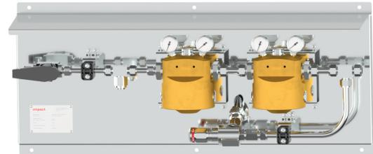
Das Gas Supply Control Panel - N2 ist eine Druckreduzereinheit, über das jede Stickstoff-Gasversorgungsanlage mit der Impact-EC-GM-Unit EvoCSII verbunden werden kann. Die Komponente ist für die Regelung von einem maximalem Eingangsdruck bis 200 bar ausgelegt. Die zweistufige Druckregelung umfasst
