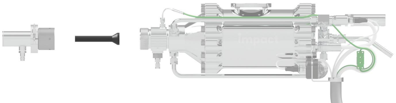
Die Düse Injector - OUT2 ist eine gekürzte Düse mit höherer Expansionsrate. Der Betrieb wird in Verbindung mit einer Luft- oder Wasserkühlung empfohlen. So lässt sich der Verschleiß und die Gefahr der Düsenverstopfung (Nozzle-Clogging) stark reduzieren.
