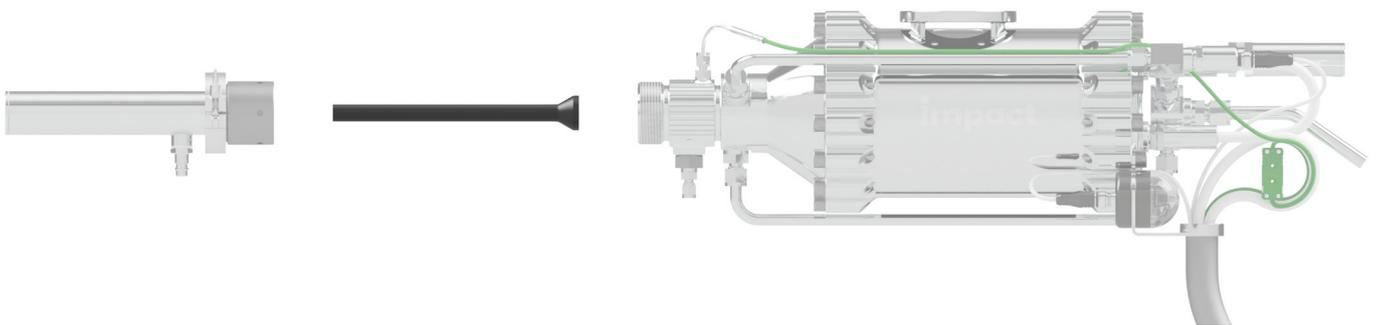
Die Düse Injector - OUT4 ist eine verlängerte Düse, speziell für höhere Partikelgeschwindigkeiten. Der Betrieb wird in Verbindung mit einer Luft- oder Wasserkühlung empfohlen. So lässt sich der Verschleiß und die Gefahr der Düsenverstopfung (Nozzle-Clogging) stark reduzieren.
