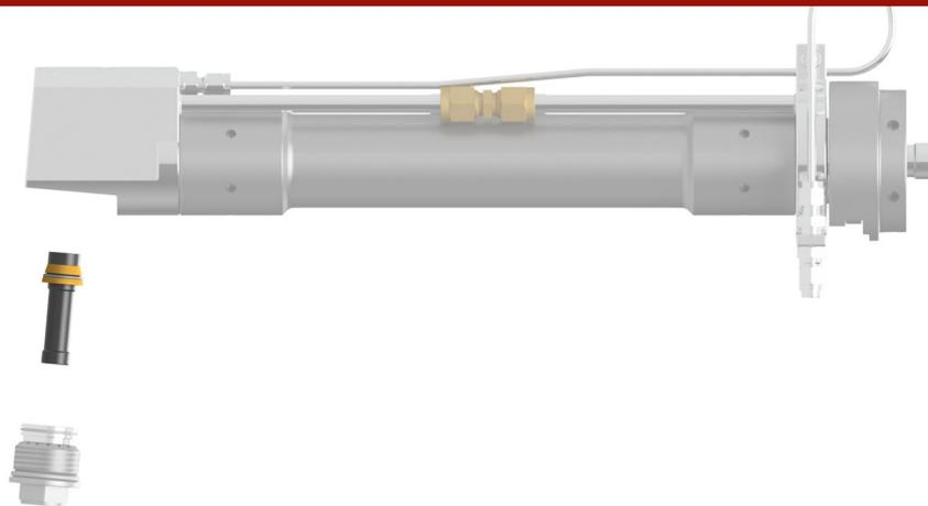
Die Düse Injector - IN3 ist für das ID Coating Device konzipiert und für Bohrungen mit einem Mindestdurchmesser von  $\varnothing 84$  mm geeignet. Der Betrieb ist ausschließlich in Verbindung mit einer Wasserkühlung möglich. So lässt sich der Verschleiß und die Gefahr der Düsenverstopfung (Nozzle-Clogging) stark reduzieren.
