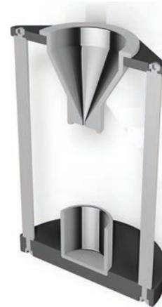
Mit dem Hall Flowmeter Kit (DIN EN ISO 4490) kann die Fließfähigkeit von diversen Pulvern schnell und präzise ermittelt werden. Der Messwert wird durch den Zeitraum, welcher erforderlich ist, damit 50 Gramm eines Metallpulvers durch einen kalibrierten Trichter fließen, ermittelt.
