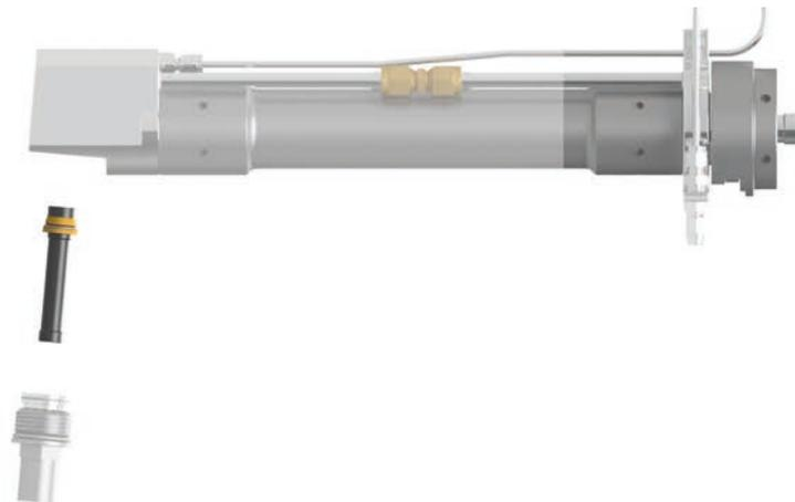
Die Düse Injector - IN2 ist für das ID Coating Device konzipiert und für Bohrungen mit einem Mindestdurchmesser von  $\varnothing 107$  mm geeignet. Aufgrund der Düsenlänge wird eine hohe Partikelgeschwindigkeit erreicht.
