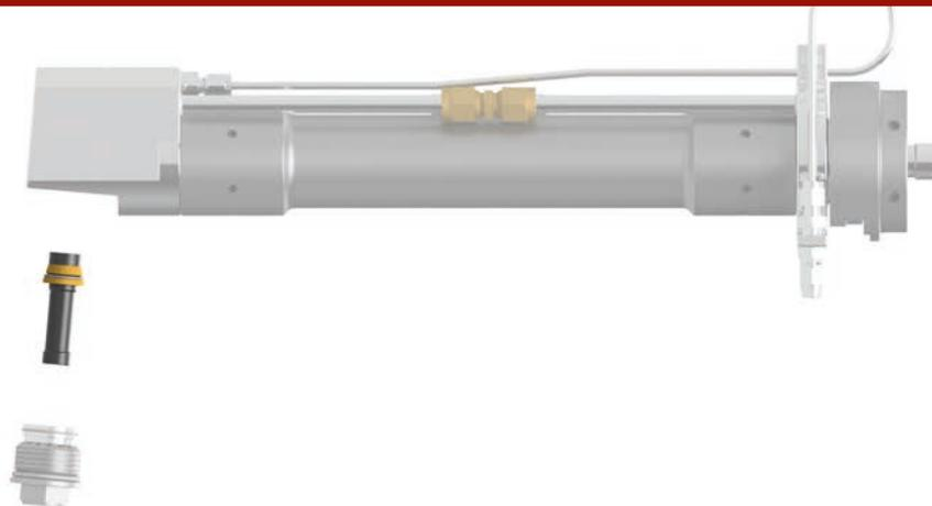
Die Düse Injector - IN3 ist für das ID Coating Device konzipiert und für Bohrungen mit einem Mindestdurchmesser von Ø84 mm geeignet. Der Betrieb ist ausschließlich in Verbindung mit einer Wasserkühlung möglich. So lässt sich der Verschleiß und die Gefahr der Düsenverstopfung (Nozzle-Clogging) stark reduzieren.
