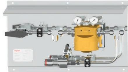
Das Gas Supply Control Panel - He ist eine Druckreduziereinheit, über das jede Helium - Gasversorgungsanlage mit der Impact-EC-GM-Unit EvoCSII verbunden werden kann. Die Komponente ist für die Regelung von einem maximalem Eingangsdruck bis 200 bar ausgelegt. Die Druckregelung umfasst einen Dom-Druck-
